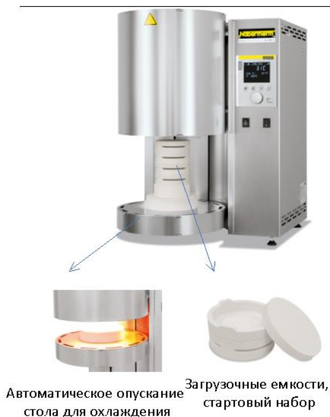
Рис. 7. Лабораторная электропечь для варки стекол (слайд 7)
