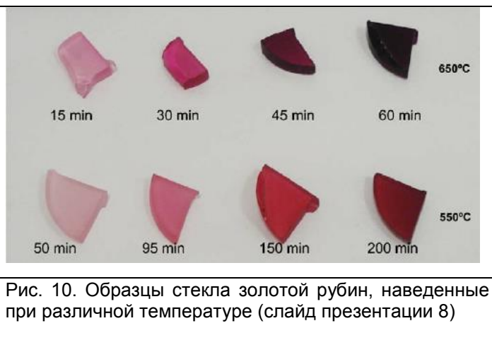
Рис.9. Режим наведения окраски стекла «золотой рубин» в электропечи
